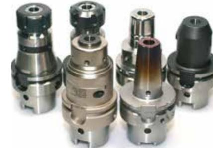
Abb. 1: Spannmittel für Zylinderschaftwerkzeuge
